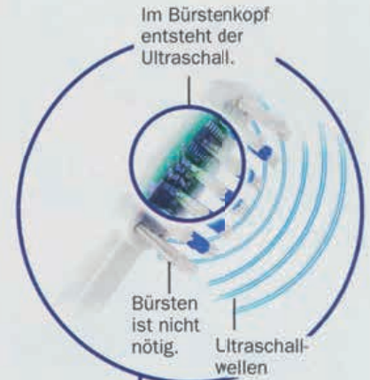
Die Zahnbürste von emmi-dent arbeitet mit Ultraschallwellen
